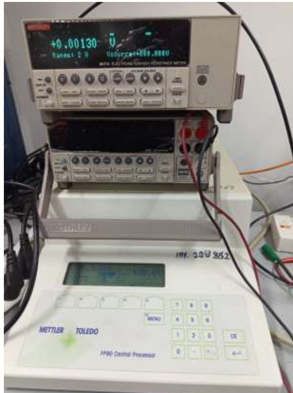
Fig. 6. Termostatul Mettler Toledo FP82HT Hot Stage și voltmetrul digital folosit în experimente
