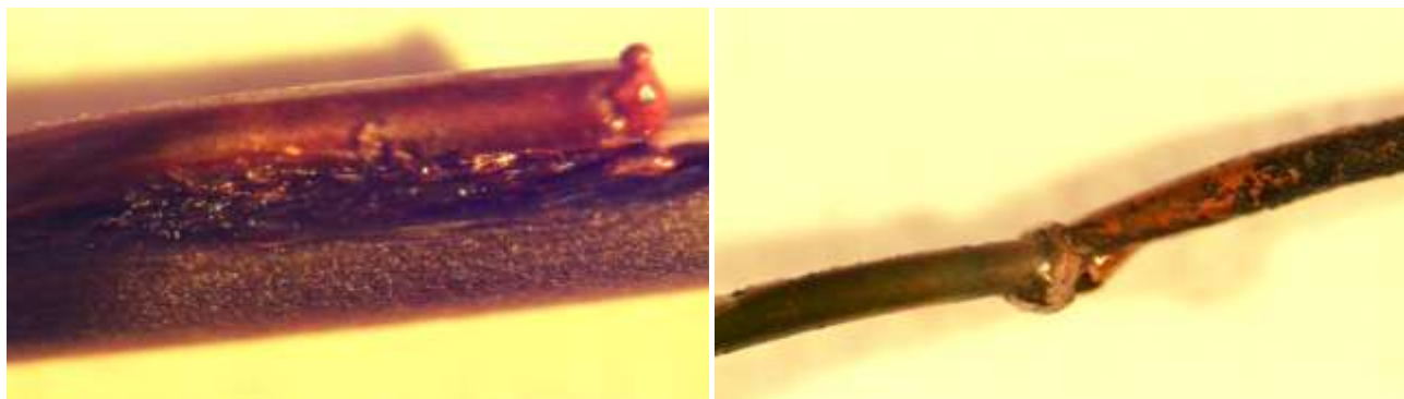
Fig. 4. Cusăturile sudate ale firelor metalice cu aplicarea DEI: a – suprapuse; b – cap-la-cap
